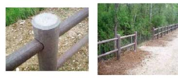
Barriere di protezione in plastica riciclata al 100% con il Marchio PSV (Plastica Seconda Vita) da raccolta differenziata, costituita da pali verticali da diam 15 cm x 150 H cm e traverse di sezione circolare da 8 x 275 cm. Sistemi di fissaggio in acciaio zincato a caldo.
