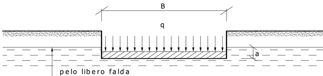
Se il pelo libero della falda è al di sotto del piano di posa della fondazione di una profondità  $d$ , tale che:
